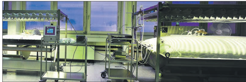
In diesen Moosbioreaktoren werden Proteine hergestellt.
